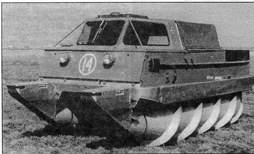
■ Шнекоход ЗИЛ-29061 Вместимость — 6 человек; полная масса — 3400 кг; два двигателя мощностью по 77 л. с.; максимальная скорость по снегу — 30 км/час; на плаву — 14,9 км/час; предельный подъем по снегу — 24,5°
