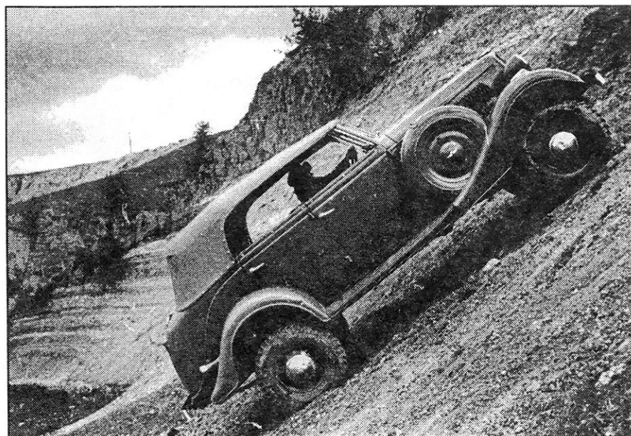
■ Преодоление на ГАЗ-61-40 предельного подъема в 41°. Район дер Великий Враг (под Кстово) Лето 1939 года
