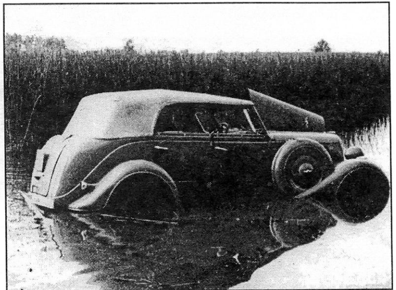
При попытке преодолеть брод глубиной 720 мм вода залила свечи, двигатель не заводился. При снятом ремне вентилятора ГАЗ-61-40 преодолел брод глубиной до 800 мм
