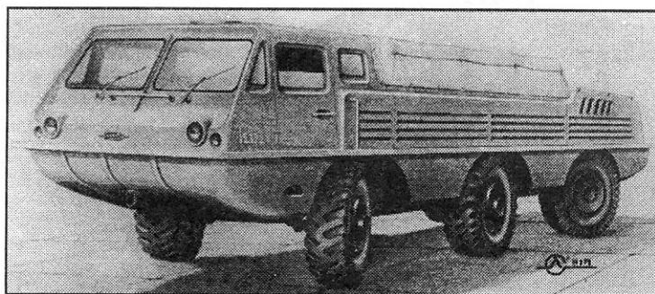
■ Проект универсального многоцелевого грузопассажирского плавающего автомобиля 6 x 6 с задним расположением силового агрегата Март 1972 года
